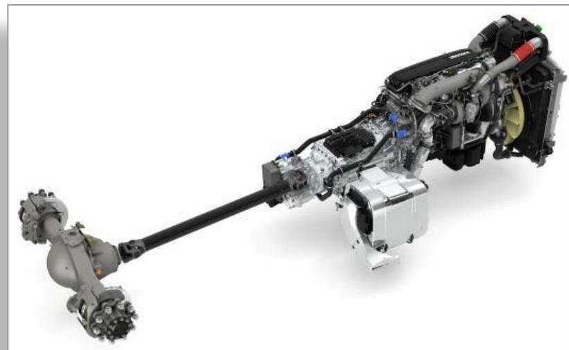
Основной вклад в поразительную топливную экономичность вносит сердце новых грузовиков, то есть новая продуманная силовая линия, состоящая из новых двигателей, систем дополнительной обработки отработавших газов, новых коробок передач и новых задних мостов.
